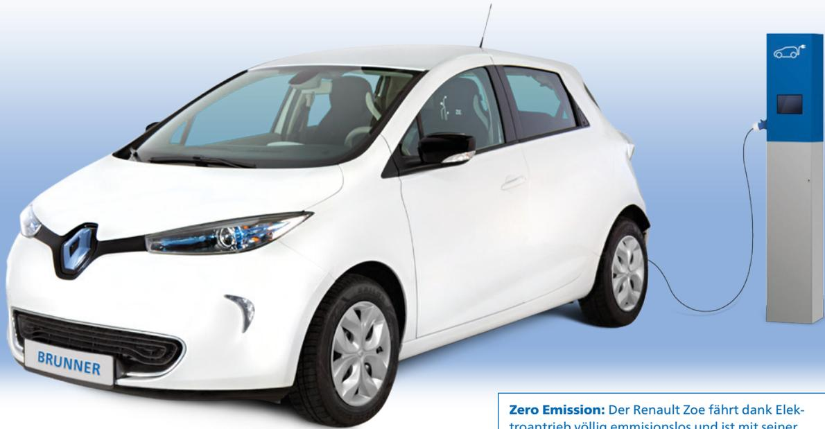
**Zero Emission:** Der Renault Zoe fährt dank Elektroantrieb völlig emissionslos und ist mit seiner Reichweite von 240 km hervorragend für den Einsatz in der Stadt geeignet. Per Schnellladeverfahren lässt sich sein Akku innerhalb von 30 Minuten auf 80 Prozent aufladen.
